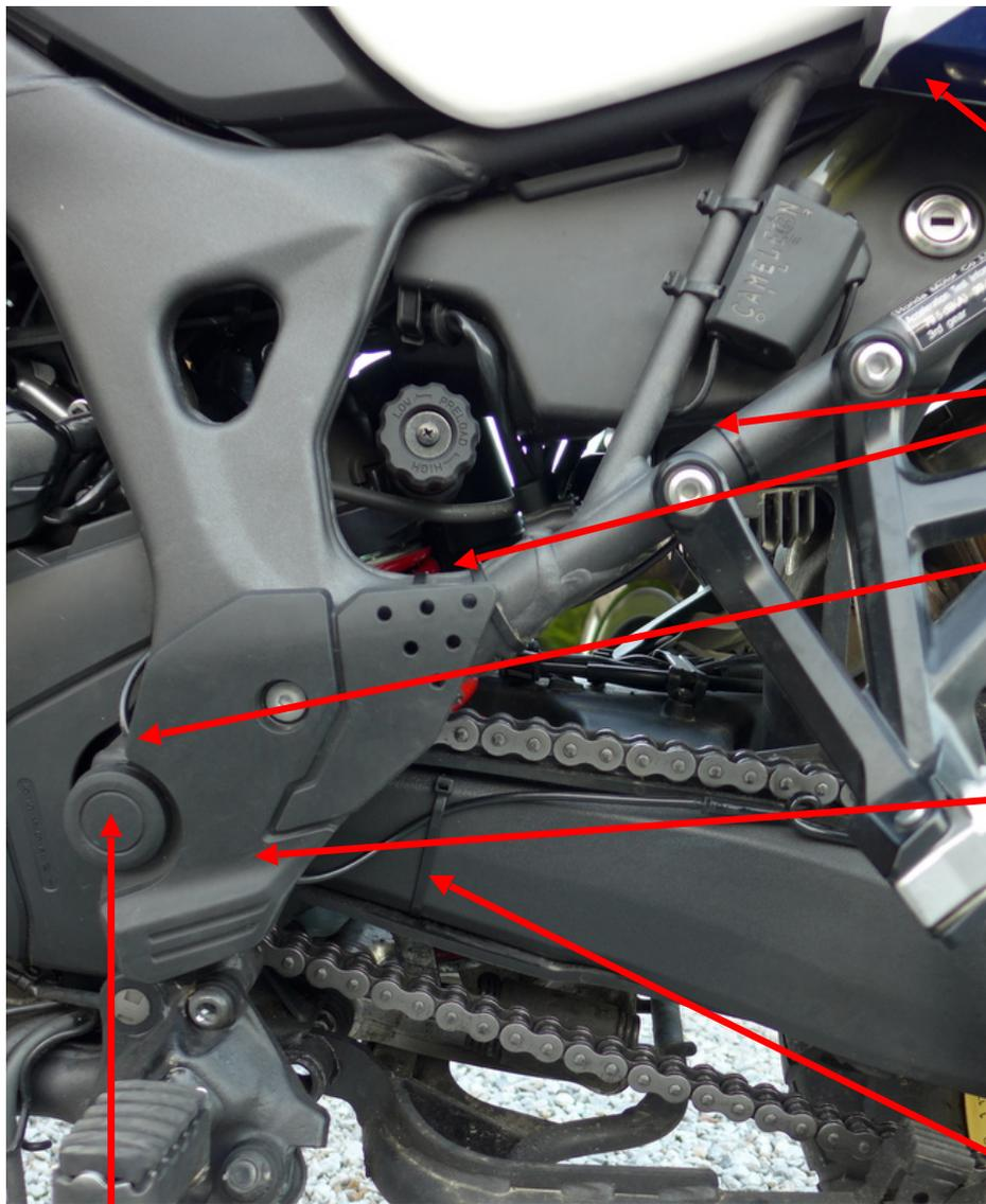
Découpage sous la selle pour le passage du tube réservoir
